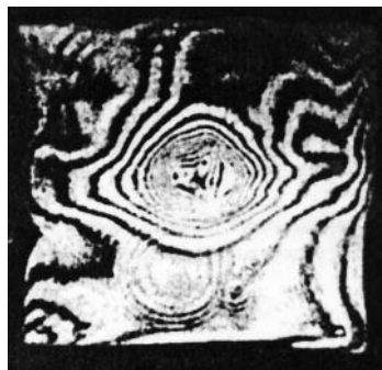
Рис. 1 б. Интерференция оптической поверхности зеркала под действием лазерного луча. Кольца в центре выявляют деформацию поверхности (журнал «Наука и жизнь» №9/1985)
