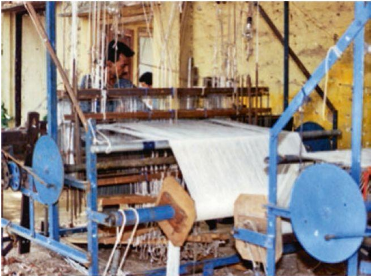
Рис. 3.2 Летающий челночный ткацкий станок - механизированный станок без электричества. Доход ткача увеличивается в 3-4 раза по сравнению с работой на традиционном ткацком станке.
